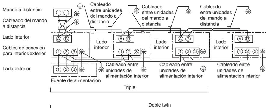
\* Utilice cables de protección de 2 núcleos (MVVS 0,5 a 2,0 mm<sup>2</sup> o más) para el cableado del mando a distancia en los sistemas simultáneo Twin, simultáneo triple y simultáneo doble Twin para prevenir problemas de ruido. Asegúrese de conectar a tierra ambos extremos del cable de protección.
