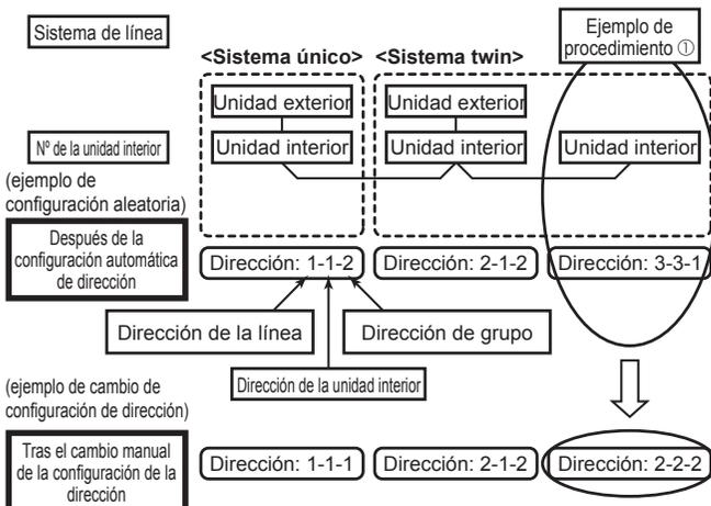
**La dirección anterior se define automáticamente al encender la unidad. No obstante, las direcciones de línea y de unidades interiores se definen de forma aleatoria. Por tal razón, cambie la configuración para que las direcciones de línea correspondan con las direcciones de las unidades interiores.**
