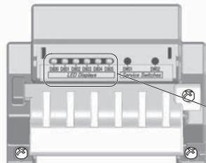
\* Los LED y los interruptores se encuentran situados en la esquina superior derecha de la placa de circuitos impresos de la unidad exterior, tal y como se muestra en la figura en la siguiente tabla.
