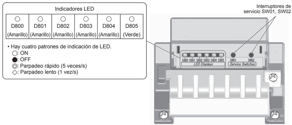
• En el estado de indicación del LED inicial, D805 se ilumina tal y como se muestra en la siguiente tabla. Si el estado inicial no está establecido (si el D805 está parpadeando), mantenga pulsados los interruptores de servicio SW01 y SW02 simultáneamente durante un mínimo de 5 segundos para que el LED recupere el estado inicial.
