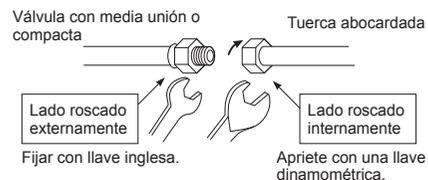
**2** Como se muestra en la ilustración, utilice las dos llaves para **añajar** o ajustar la tuerca abocinada de la válvula del lateral del gas. Si utiliza una sola llave, no podrá ajustar la tuerca abocinada con el par de apriete necesario.
