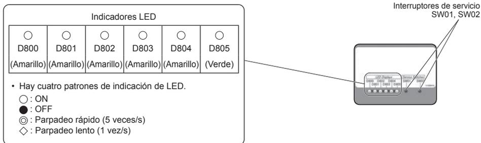
• En el estado de indicación del LED inicial, D805 se ilumina tal y como se muestra en la siguiente tabla. Si el estado inicial no está establecido (si el D805 está parpadeando), mantenga pulsados los interruptores de servicio SW01 y SW02 simultáneamente durante un mínimo de 5 segundos para que el LED recupere el estado inicial.
