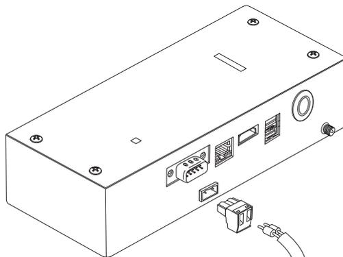
El cable de comunicación Uh Line debe conectarse a tierra en el acondicionador de aire.
