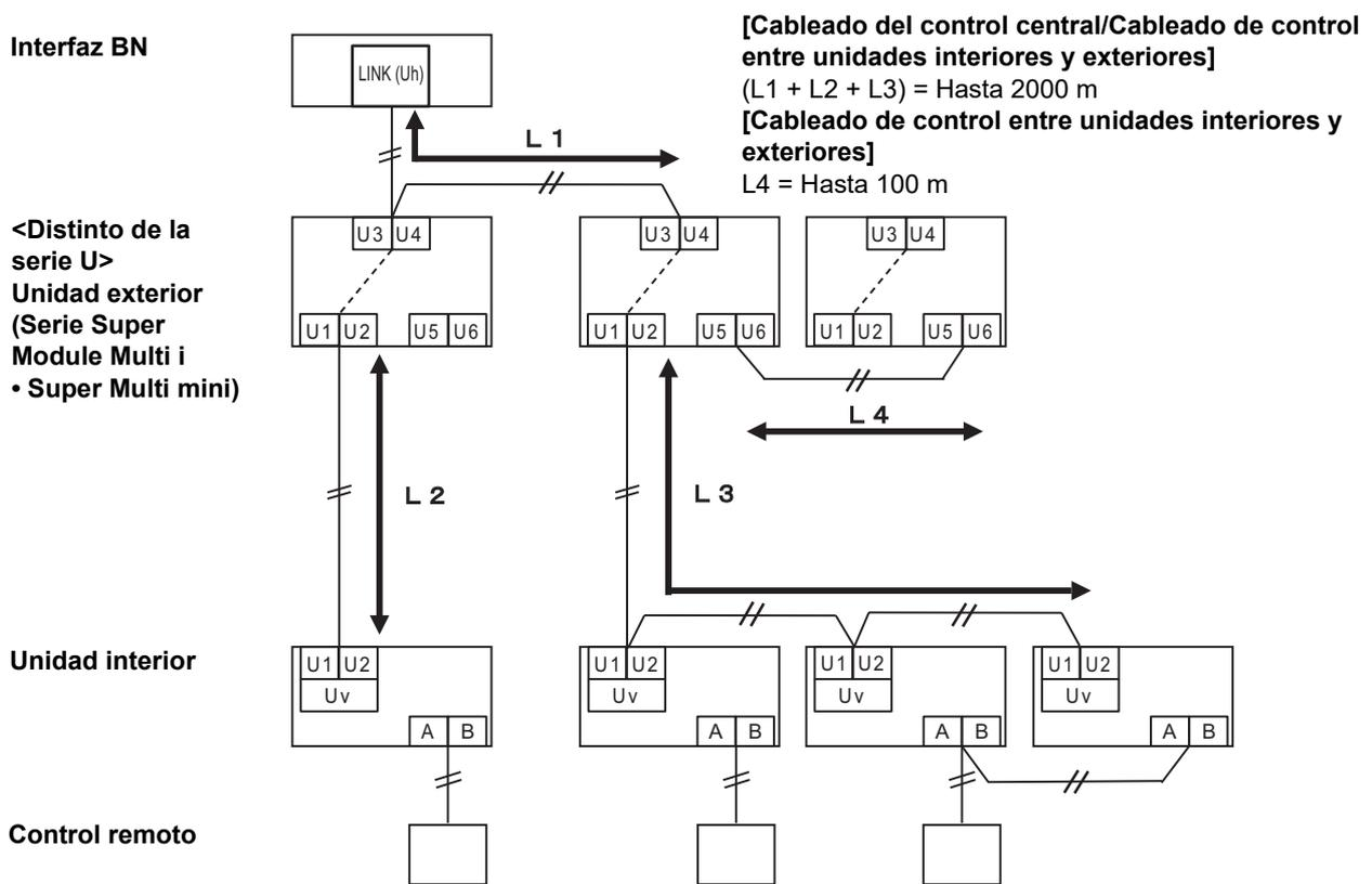
**Cuando se conecta a un modelo anterior de aparato de aire acondicionado comercial ligero, intercambiador de calor aire-aire, bomba de calor de aire a agua o interfaz de control del equipo de uso general**
