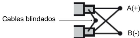
Los cables blindados deben prensarse con conectores de extremo cerrado en interfaces con direcciones distintas a 1 y los extremos de los cables no blindados.
