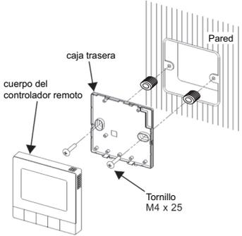
1. Inserte un destornillador tipo ranura o similar en el lado inferior del cuerpo del control remoto, y gírelo para retirar la cubierta posterior.
