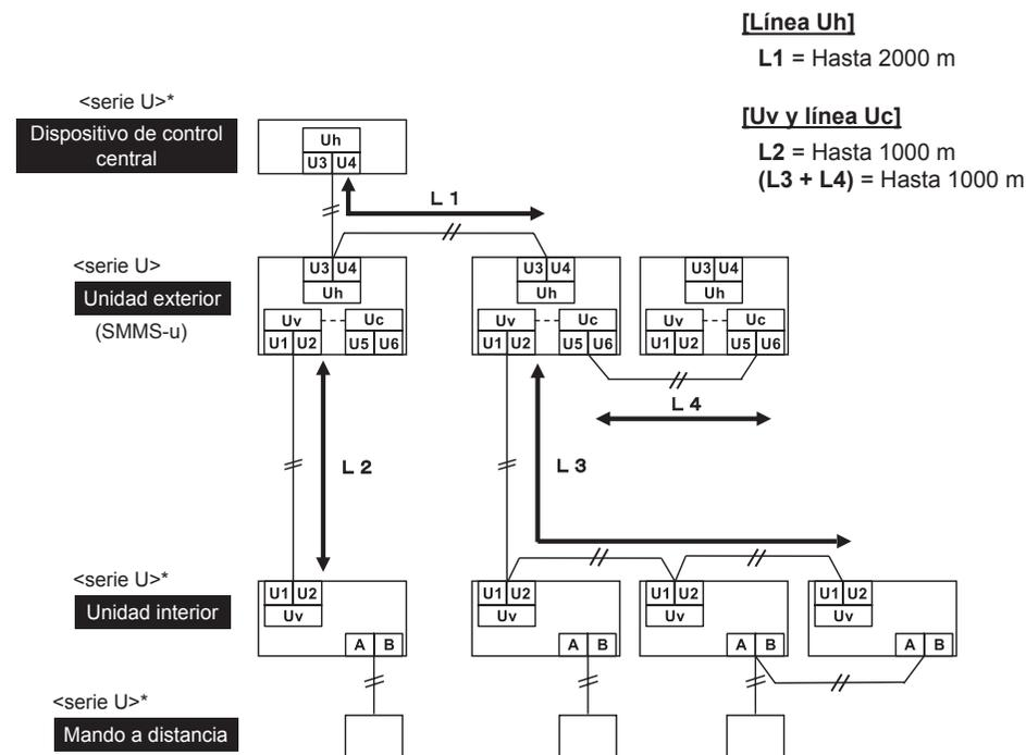
\* Incluso si las unidades interiores, los mandos a distancia y el dispositivo de control central son modelos distintos de la serie U, sus diagramas del sistema para las especificaciones de cableado son los mismos que el diagrama del sistema anterior.
