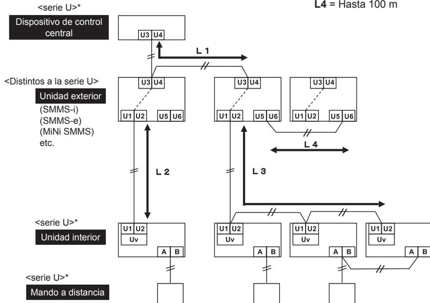
\* Incluso si las unidades interiores, los mandos a distancia y el dispositivo de control central son modelos distintos de la serie U, sus diagramas del sistema para las especificaciones de cableado son los mismos que el diagrama del sistema anterior.
