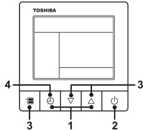
**1** Pulse y mantenga pulsado el botón OFF del temporizador y el botón de ajuste [△] simultáneamente durante 10 segundos o más. Aparece [TEST] en la pantalla y se habilita el modo de prueba.
