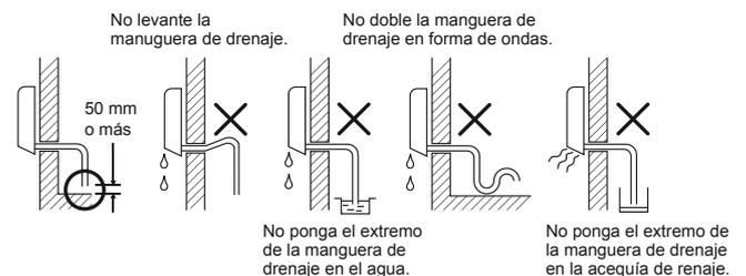
2. Ponga agua en el depósito de drenaje y asegúrese que el agua se drene hacia afuera.
