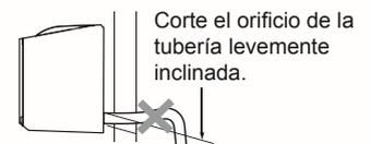
Haga el orificio para la tubería levemente inclinado.
