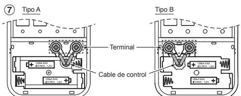
\* Los terminales para el cableado pueden estar a la derecha (tipo A) o izquierda (tipo B), dependiendo del controlador embalado en la caja.
