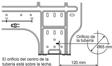
1. Después de determinar la posición del orificio de la tubería con la placa de montaje (➡), perforo el orificio de la tubería (Ø65 mm) ligeramente inclinado hacia abajo al lado exterior.
