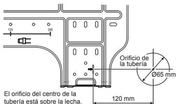
1. Después de determinar la posición del orificio de la tubería con la placa de montaje (➔), perforo el orificio de la tubería (Ø65 mm) ligeramente inclinado hacia abajo al lado exterior.
