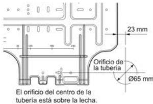
1. Después de determinar la posición del orificio de la tubería con la placa de montaje (➡), perforo el orificio de la tubería (Ø65 mm) ligeramente inclinado hacia abajo al lado exterior.
