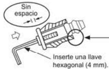
No utilice aceite lubricante (aceite para maquinaria refrigerante) al insertar la tapa del desagüe. Su uso provoca que el enchufe se deteriore y tenga fugas.
