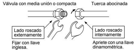
**2** Como se muestra en la ilustración, utilice las dos llaves para aflojar o ajustar la tuerca abocinada de la válvula del lateral del gas. Si utiliza una sola llave, no podrá ajustar la tuerca abocinada con el par de apriete necesario.
