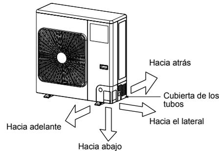
• Los tubos de conexión de la unidad interior y la exterior se pueden conectar en cuatro direcciones. Retire la parte prepunzonada de la cubierta de los tubos, por la que pasan los tubos o los cables a través de la placa de base.
