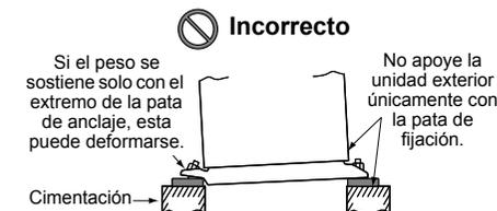
Ajuste el margen externo del perno de anclaje a 15 mm o menos.
