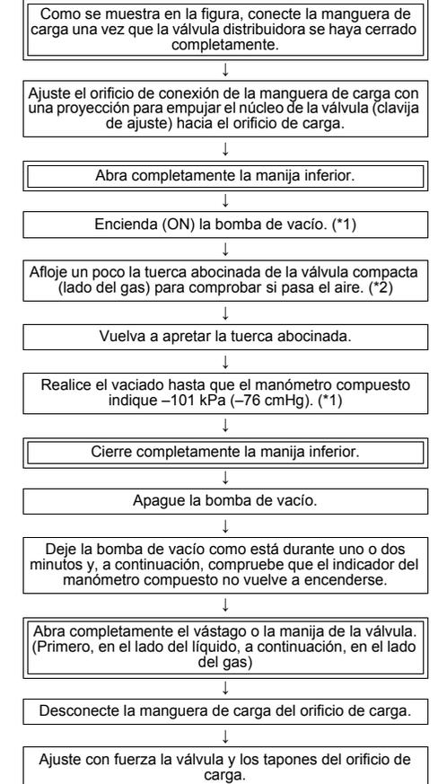
\*1: Utilice correctamente la bomba de vacío, el adaptador de la bomba de vacío y el manómetro (antes de utilizarlos, consulte los manuales suministrados con cada herramienta). Compruebe también que el aceite de la bomba de vacío llega hasta la línea especificada en la varilla del nivel de aceite.
