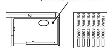
Mirilla de inspección para comprobar las indicaciones de los LED
