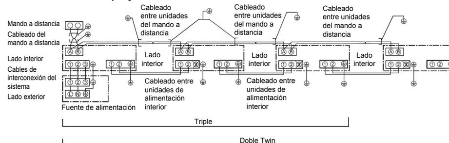
\* Utilice cables de protección de 2 núcleos (MVVS 0,5 a 2,0 mm<sup>2</sup> o más) para el cableado del mando a distancia en los sistemas simultáneo Twin, simultáneo triple y simultáneo doble Twin para prevenir problemas de ruido. Asegúrese de conectar a tierra ambos extremos del cable de protección.
