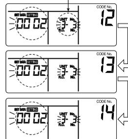
**7** Una vez comprobado los cambios, pulse el botón **TEST**. (La configuración queda determinada.) Al pulsar el botón **TEST**, desaparecen las indicaciones y la unidad vuelve al estado normal de parada. (Después de pulsar el botón **TEST** no se podrá utilizar el mando a distancia durante aproximadamente 1 minuto.)
