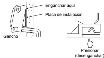
Para desenganchar la unidad interior de la placa de instalación, tire de ella hacia usted mientras la empuja hacia arriba desde las partes especificadas.
