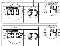
**6** Si desea modificar la configuración de otra unidad interior, repita los pasos del 2 al 5. Una vez que haya terminado con el proceso de configuración, pulse **UNIT LOUVER** para seleccionar el UNIT No. interior antes del cambio de configuración, indique CODE No. [12], [13] y [14] por este orden con los botones **TEMP.** (▼) / (▲) y, a continuación, compruebe los valores modificados.
