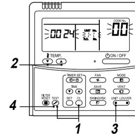
**1** Pulse los botones y simultáneamente durante al menos 4 segundos para activar el modo de control de mantenimiento.
