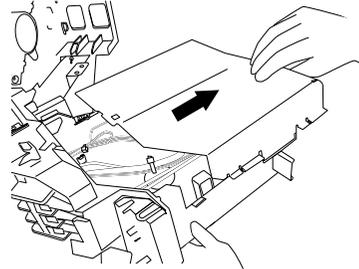
**4 Desmonte la cubierta de la caja de control eléctrico y ajuste bit1 de SW01 en el tablero a ON.**
