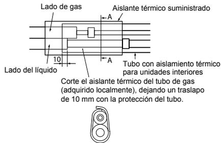
**Sección transversal A-A del aislante térmico**
