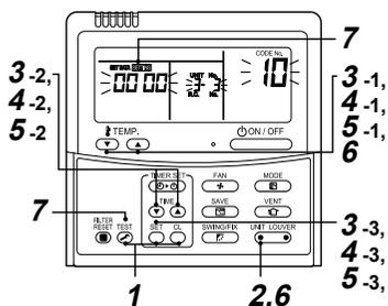
**1** Pulse simultáneamente los botones **TEST** + **CL** durante 4 segundos o más. Transcurrido este tiempo, los indicadores empezarán a parpadear en la pantalla. Compruebe que el CODE No. que aparece sea [10].
