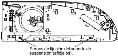
**3** Ajuste la longitud de los dos pernos que sirven para fijar el soporte de suspensión, como se muestra a continuación.
