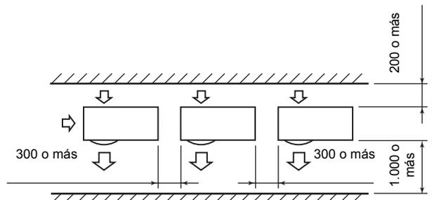
**Instalación en serie en la parte delantera y posterior**
