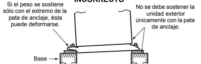
Ajuste el margen externo del perno de anclaje en 15 mm como máximo.
