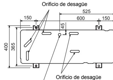
Orificio de montaje de la boquilla de desagüe
