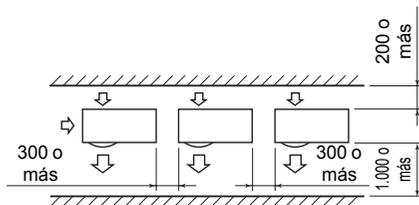
**Instalación en serie en la parte delantera y posterior**
