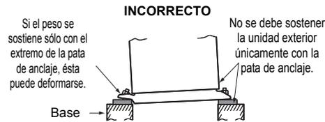
Ajuste el margen externo del perno de anclaje en 15 mm como máximo.
