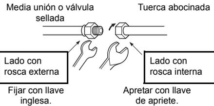
2. Como se muestra en la ilustración, utilice las dos llaves para aflojar o ajustar la tuerca abocinada de la válvula del lateral del gas. Si utiliza una sola llave, no podrá ajustar la tuerca abocinada con el par de apriete necesario. En cambio, deberá utilizar una sola llave para aflojar o ajustar la tuerca abocinada de la válvula del lado del líquido.
