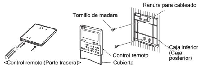
1. Para desmontar la caja inferior (caja posterior) del control remoto, inserte la punta de un destornillador plano, etc., en las dos aberturas de la parte inferior del control remoto, para abrir la caja inferior.
