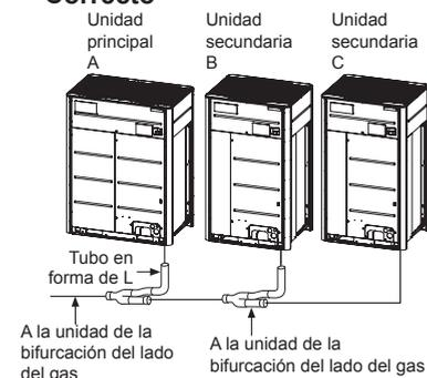
[Conexión vertical de las unidades de derivación]
