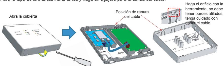
2. Fíjela en la pared o en el tabique siguiendo la posición de fijación, conecte el cable entre la interfaz inalámbrica y la unidad Hydro.
