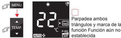
2. Introduzca el ajuste CHIMENEA pulsando el botón MENU. La marca del triángulo dejará de parpadear y la función de ajuste parpadeará en su lugar.
