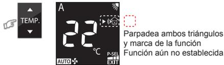
2. Introduzca el ajuste SILENCIO pulsando el botón MENU. La marca del triángulo dejará de parpadear y la función de ajuste parpadeará en su lugar.
