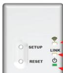
Solo LED DE POTENCIA ENCENDIDO (ON).
