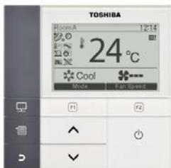
Una vez instalado, el interfaz DX LC/VRF DX no necesita tener un controlador remoto por cable conectado, aunque es útil tenerlo para diagnóstico de errores y estado de funcionamiento.
